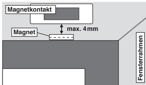
**ACHTUNG** Der Sitz des Magnetkontaktees ist durch eine Einkerbung am Gehäuse des Fensterkontaktees gekennzeichnet.
