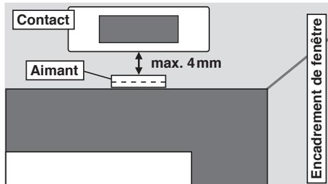
**ATTENTION** Une rainure sur le boîtier du contact permet de définir le bon positionnement de l'aimant.
