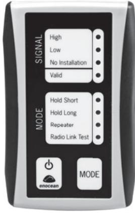
Das EPM 300 ist ein mobiles Feldstärke-Messgerät, das die Feldstärke von empfangenen EnOcean Telegrammen und von Störquellen im Bereich 868MHz anzeigt. Es dient dem Elektroinstallateur zur Bestimmung der optimalen Montageorte für Sender und Empfänger.
