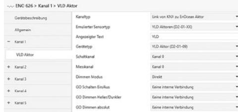
Mit diesem Profil können verschiedene bidirektionale EnOcean-Schalt- oder Dimmaktoren dieser EEP-Familie benutzt werden.
