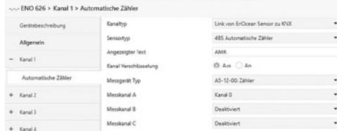
Pro Kanal werden maximal drei Zählerkanäle unterstützt. Die Zählerkanäle, die das EnOcean-Gerät sendet, müssen bekannt sein und im Parameter eingestellt werden. Für jeden Zählkanal stehen zwei Kommunikationsobjekte zur Verfügung, jeweils ein Wert für den aktuellen Verbrauch und für den Gesamtverbrauch.
