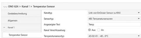
Bei den Temperatursensoren werden verschiedene Messbereiche unterstützt. Der Temperatur-Messwert wird auf einen 2 Byte Fließkommawert abgebildet.
