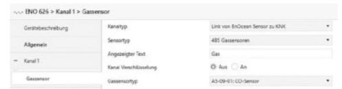
Bei allen Sensoren ist die Gaskonzentration als Objekt verfügbar, abhängig vom EPP des Sensors können noch weitere Messwerte auf KNX versendet sein werden:
